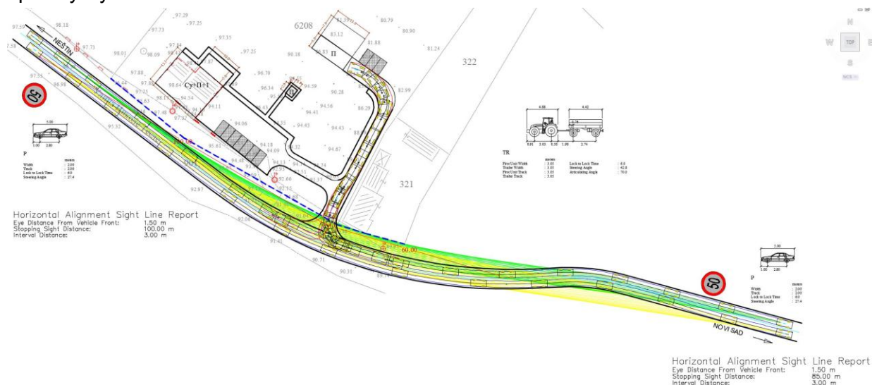
Слика бр. 8.1: Криве трагова меродавног возила и зоне прегледности на саобраћајном прикључку
