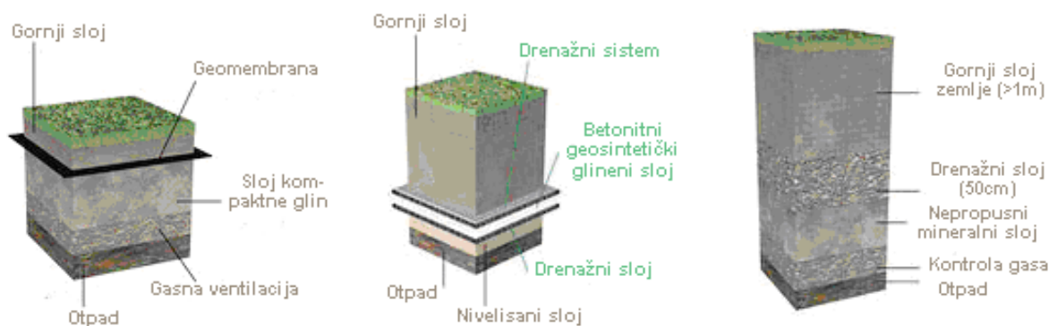
Slika 5.13 Prikaz gornjih pokrivnih slojeva deponije
