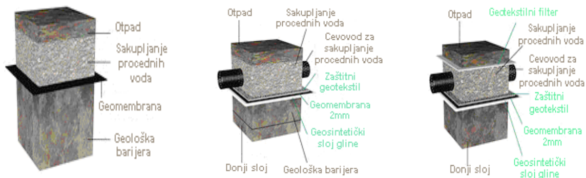
Slika 5.17 Prikaz donjih slojeva deponije
